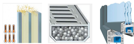
Abbildung 2: Krypton 3-Fach-Verglasung, Edelstahl-Abstandshalter 6-Kammer-Wärmedämmprofil
