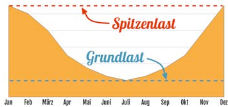
Abbildung 8: Wärmebedarf über das Jahr gesehen
