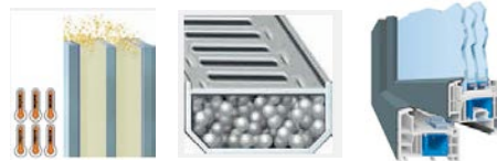
Abbildung 2: Krypton 3-Fach-Verglasung, Edelstahlabstandhalter 6-Kammer-Wärmedämmprofil
