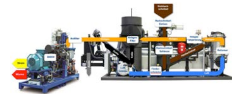
Abbildung 5: Beispiel Holzvergase-BHKW Fa. Spanner
