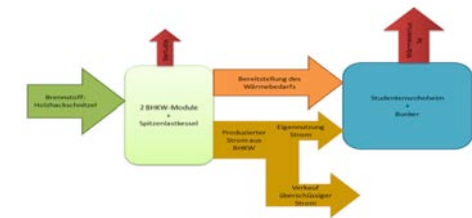
Abbildung 6: Qualitative Energiebilanz der Heiztechnik
