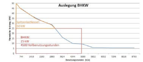
Abbildung 4: Auslegung des BHKW
