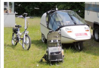
Elektromobil/ -fahrrad, Mess-Rucksack für Luftschadstoffe und Lärm und befahrene Routen
